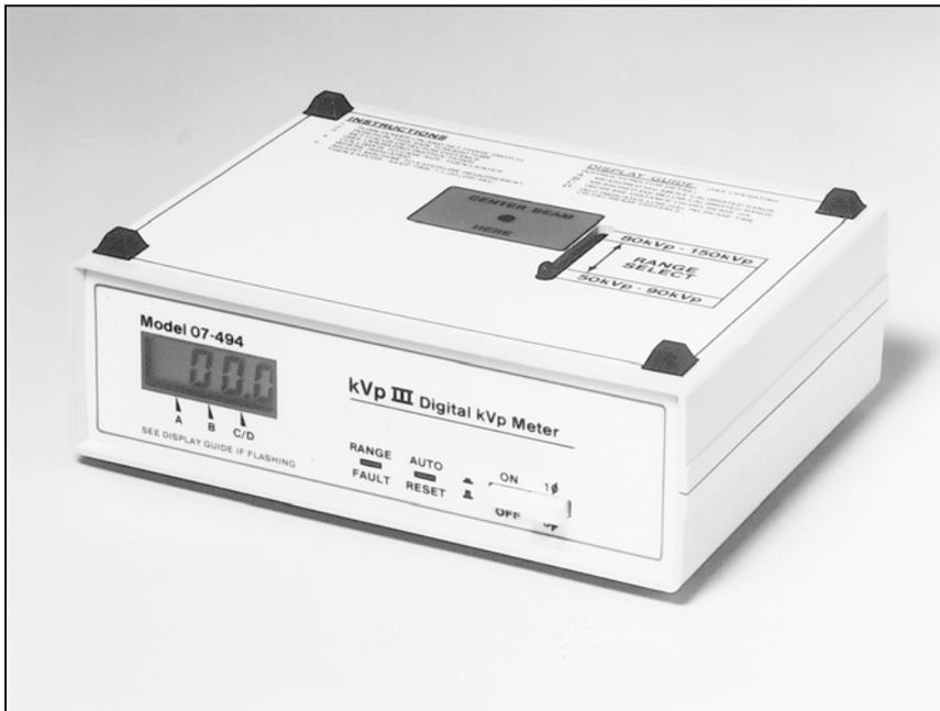
Figure 1-1. Model 07-494 Wide-Range Digital kVp Meter
